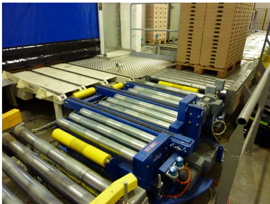
Photo : 8284 3 170 Légende : Table tournante transfert entrée tunnel de froid
